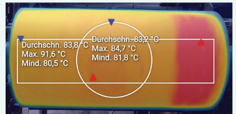
Abb. 18: Thermographie eines Betriebsversuch zur Profilierung bei 100 % Leistung. Die Maschine fuhr nur um 3,5 % nach vorne, nicht die erwarteten 10 % bis 14 %. Der führerseitige Rand ist knapp 9°C wärmer 22
