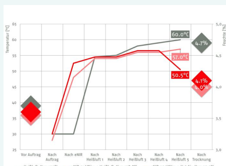
Abb. 15: Temperaturkurve und Feuchte eines Barrierestrichs mit Heißlufthaube sowie Booster plus Heißlufthaube zur Strichrocknung 21
