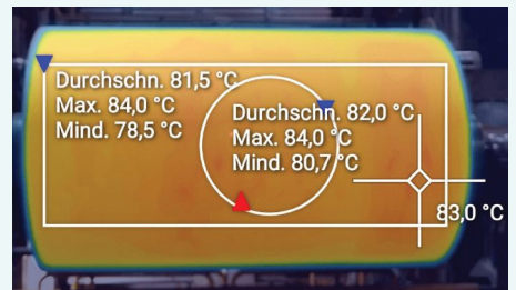
Abb. 17: Thermographie eines Betriebsversuch zur Profilierung bei 0 % Leistung
