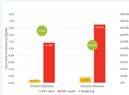
Abb. 12: Veränderung der spezifischen Verdampfungsrates als Funktion der Kapillarität des Substrats in Abhängigkeit von der Wellenlänge des Strahlers 18
